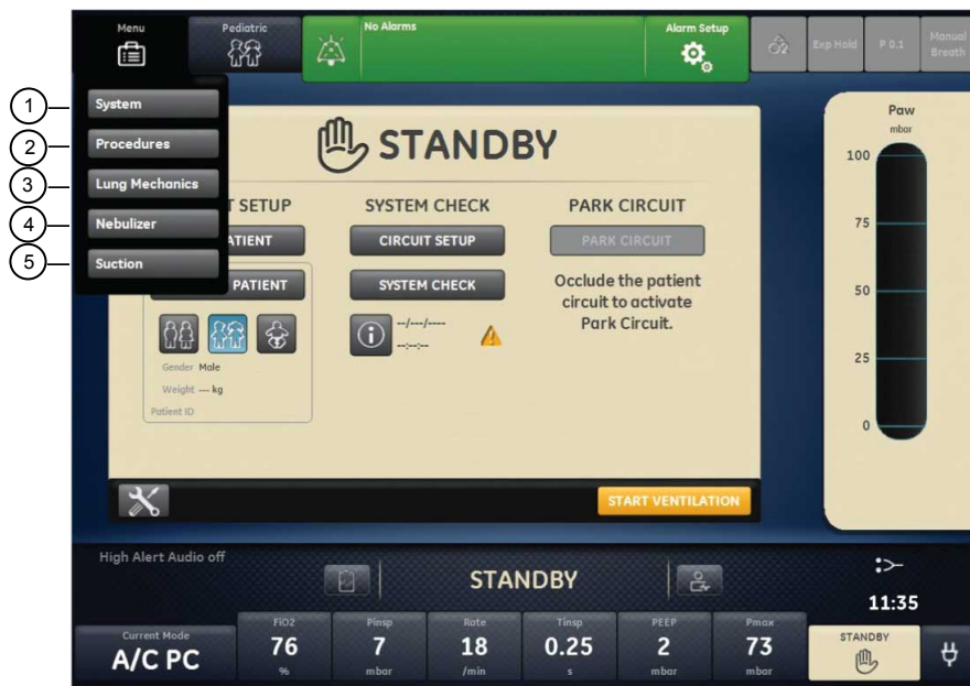
Figura 3-5 • El menú principal da acceso a las opciones de Sistema, Procedimientos, Mecánica del pulmón, Nebulizador y Aspiración.
