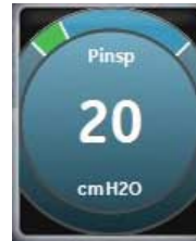
Figura 3-6 • Se muestra la imagen del Trim Knob para indicar que es preciso utilizarlo para cambiar o confirmar un ajuste.
